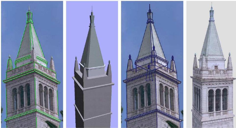
FIG. 2.6 – Le fameux modèle du campanile [DTM96]. De gauche à droite : la photographie originale et les arêtes marquées, le modèle de base reconstruit, projection des arêtes du modèle sur la photographie et rendu synthétique obtenu.
