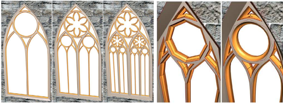
FIG. 3.27 – Le langage GML [HF01]. À gauche : une fenêtre gothique générée par application récursive de fonctions génériques. À droite : deux niveaux de détails produits par l'utilisation des surfaces de subdivision sur certains sommets du modèle.
