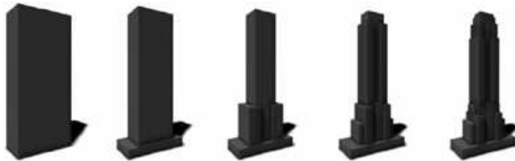
FIG. 3.15 – Cinq pas de la génération d’un bâtiment. L’axiome du L-system étant la boîte englobante du bâtiment, on a ainsi différents niveaux de détails. [PM01].
